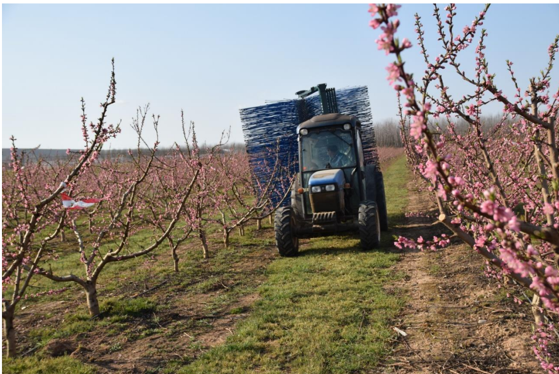
Figura 6.- Imagen del Cepillo Eclairvale 2500 ® realizando el aclareo en floración en la variedad Tiffany ov (23 de marzo de 2015).
